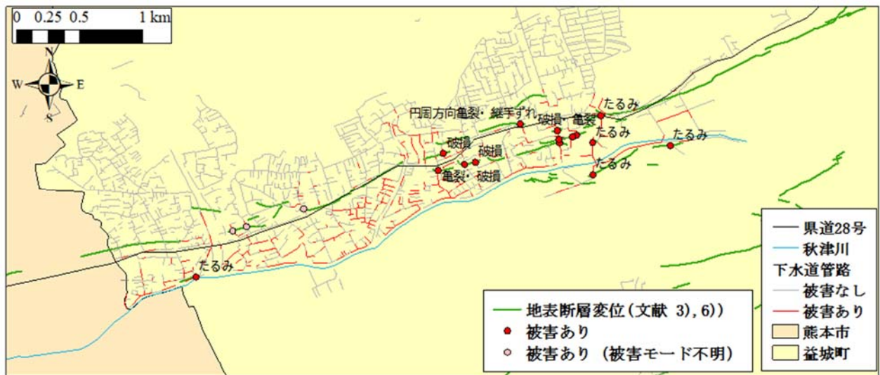
図 4.3 益城町における下水道埋設管の被害形態
