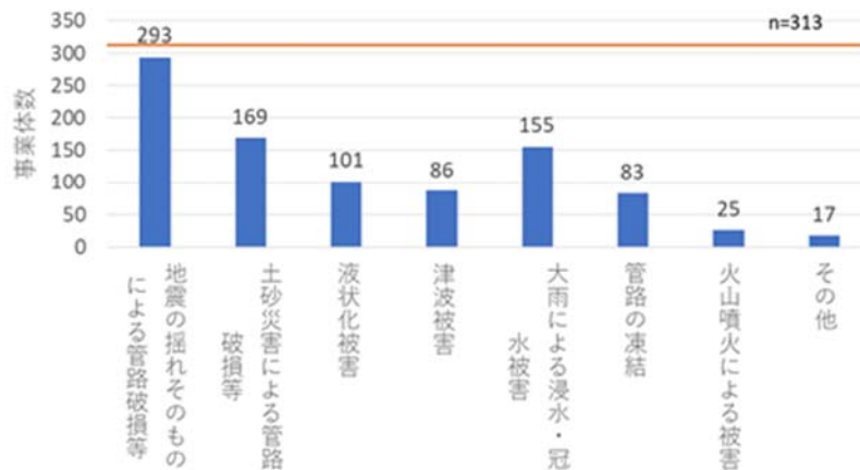
図 8.5 防災計画で想定している被害【管路】
