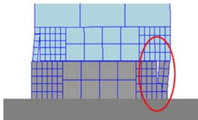
図11.15 要素境界での縦割れ
