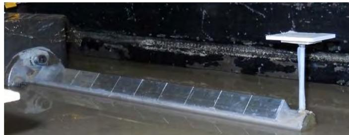
図 8.6 アンゲルによる液状化対策工を施した管路模型 (Model D)
